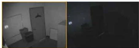
Illuminateurs IR PoE intégrés Illustra : montrés en fonctionnement à la gauche et lorsqu'ils ne fonctionnent pas à la droite.
